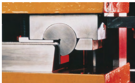
Überbiegen – Werkzeug geschlossen
